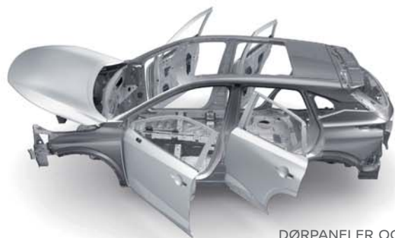
DØRPANELER OG PANSER I ALUMINIUM Lettene aluminiumspaneler i dører og panser bidrar til lavere vekt og redusert CO 2 -utslipp.
